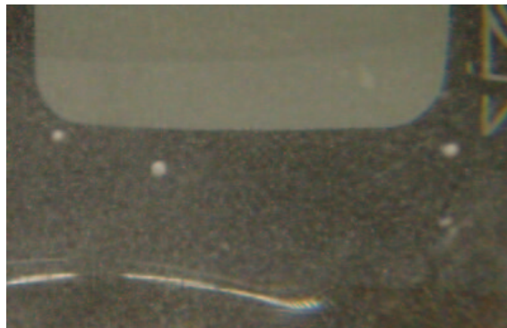
Abbildung 11: Partikelbällchen, die sich bei Ultraschalleinwirkung bilden
